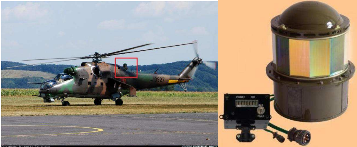
Pulsed cesium vapor arc lamp - L-166V-11E
